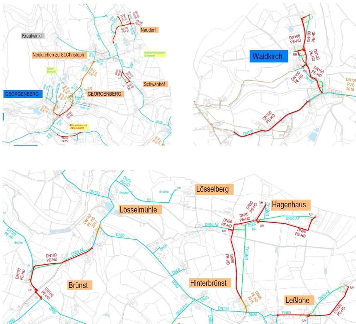
Hellblau: Bestandsleitungen / Orange: bereits erneuerte Leitungen / Rot: geplanter Leitungsneubau
